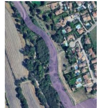
Exemple de l'adaptation du tracé de la digue au lieu-dit Quiquillon pour limiter l'impact sur le boisement existant
